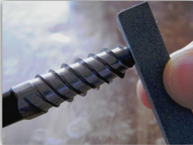
Figura 6a. Eliminación de óxido y/o desportilladuras de la punta roscada con la piedra plana de afilado.
