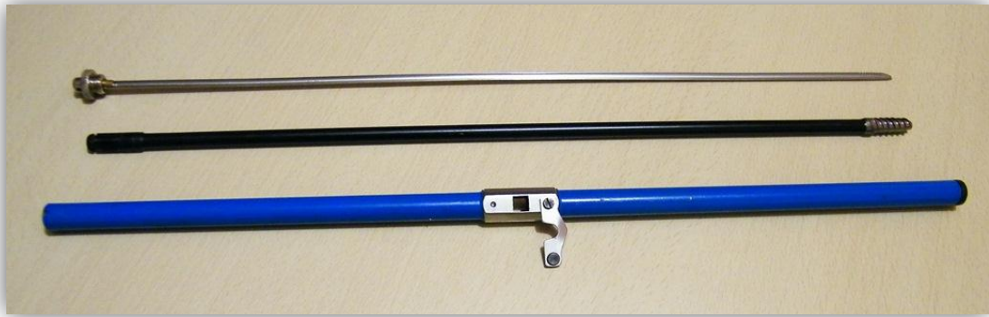
Figura 2. Barreno de Pressler de 21 pulgadas de longitud (marca Haglöf).
