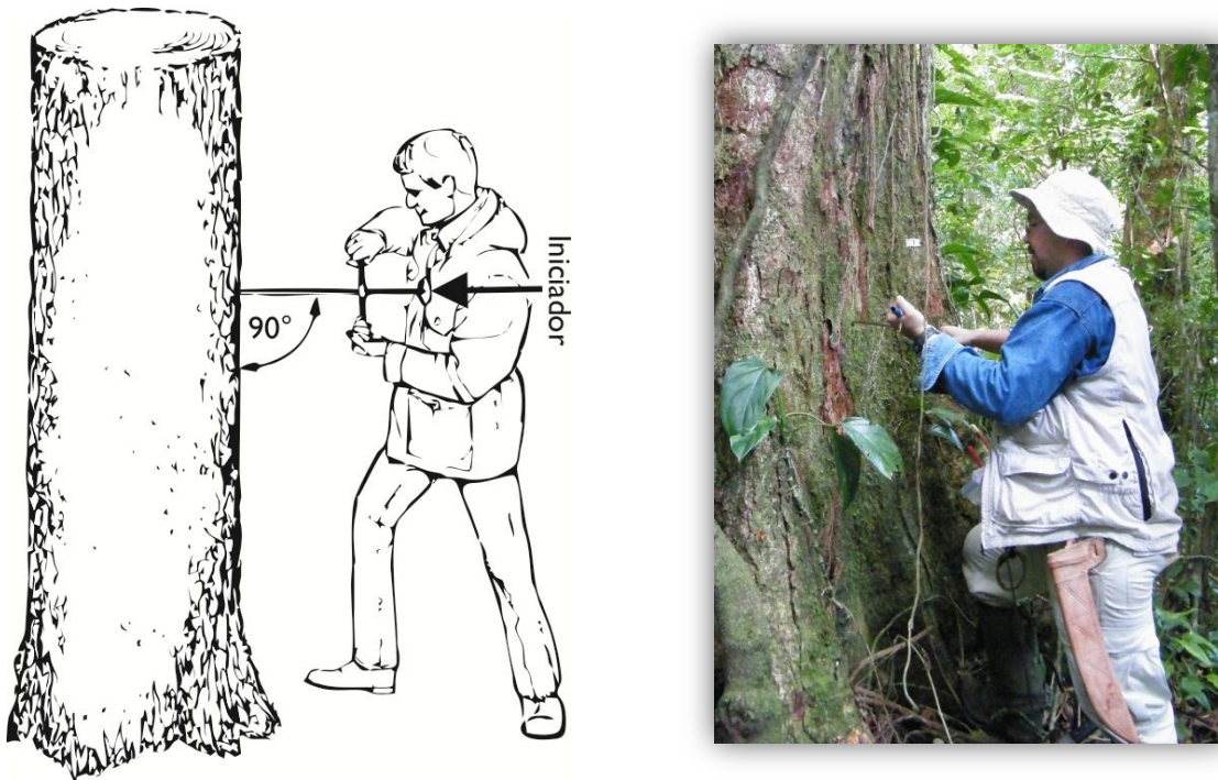
Figura 12. Insertado del barreno de Pressler a la altura del pecho (1.3 m). (Esquema modificado de Jozsa, 1988)
